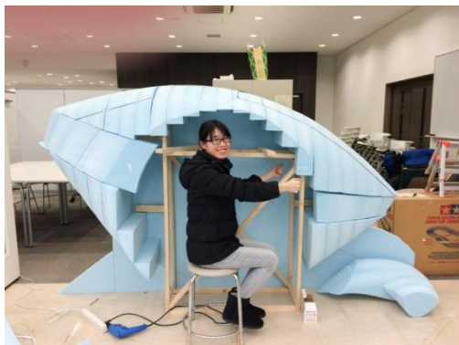
図5 木製中枠装着と乗車姿勢確認
