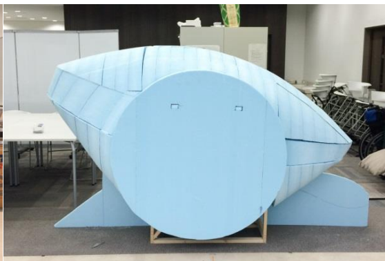
図6 完成したクレイモデルの芯
