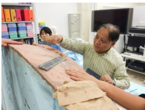
図7 クレイの盛り付け作業
