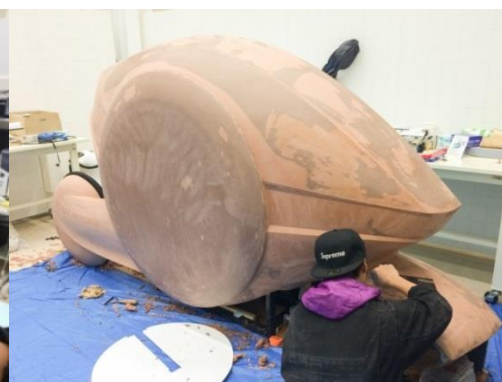
図8 完成したクレイの盛り付け
