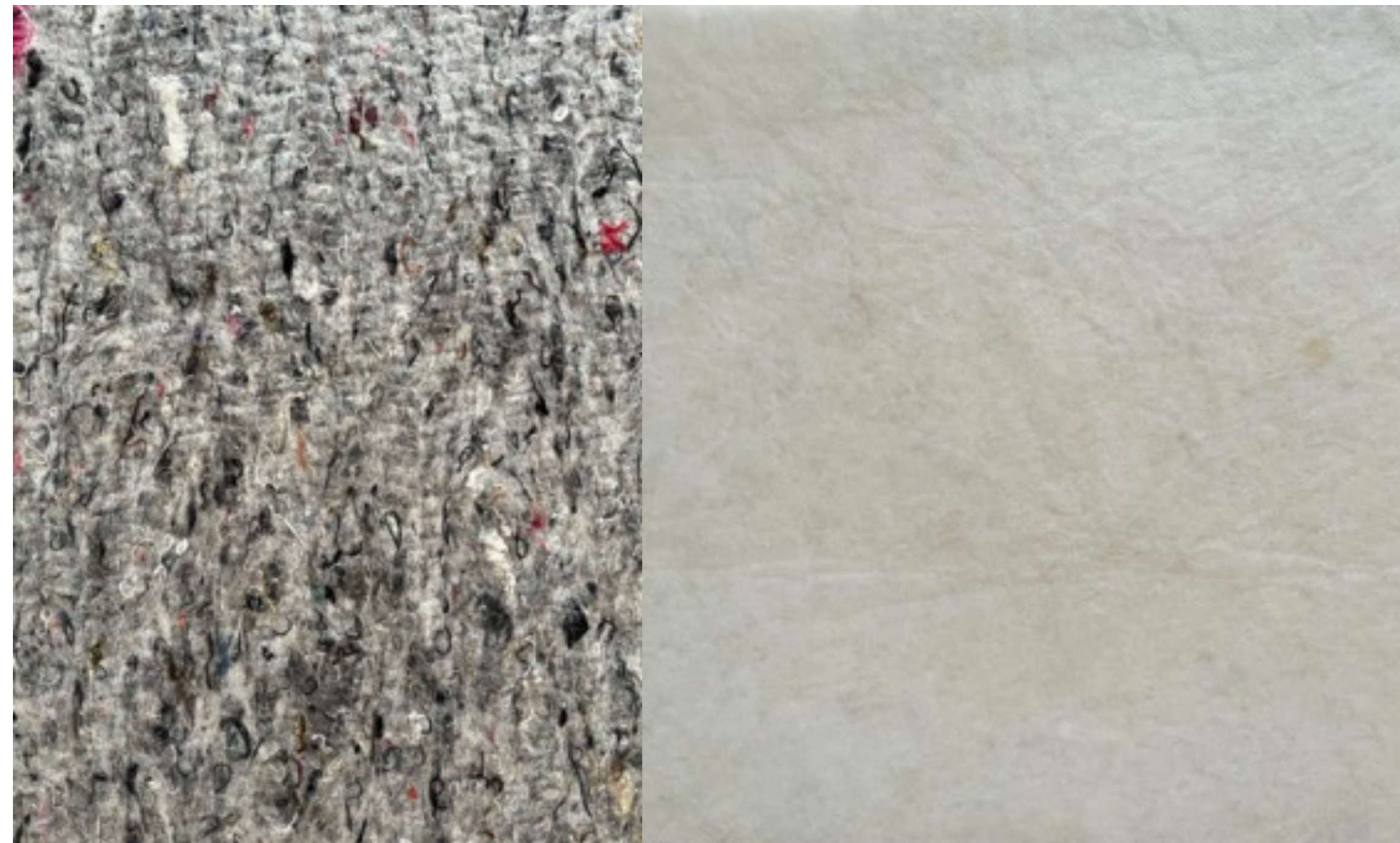
・ 廃棄された衣類を加工したフェルト ・ 工場内廃棄物や規格外品を再利用したフェルト
